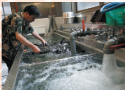
生地に残った染着していない染料や薬剤、糊料を洗い落とす。この水洗いがよくできていないと、染めや生地に不具合が出る。
