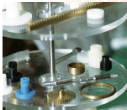
大小が重なる重ね歯車、内側に歯がある内接歯車など、製作している歯車のサンプル。
