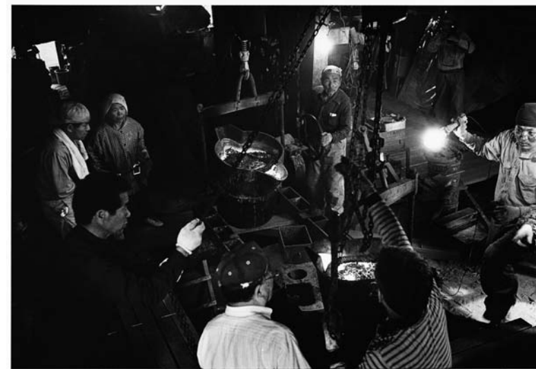
写真上：最後の鑄物師、鈴木文吾さんは、自ら製作した代々木競技場の聖火台を毎年磨きに行っていた。奥さんとともに写っているのは珍しい。 写真下：仲間や家族が総出で梵鐘の湯入れをしているところ。
